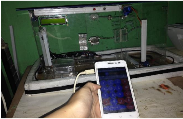
Gambar 7. Proses Kontrol Password Pintu Otomatis
