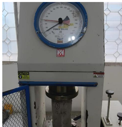
Gbr. 3. Pengujian Kuat Tekan Beton
