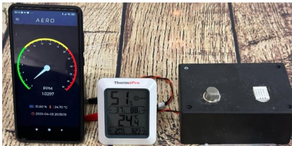
Gambar 6. Komparasi Data Sensor dengan Thermohygrometer
