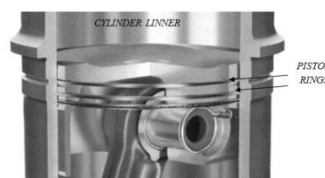
Gambar 1 Gesekan Piston Rings dengan Cylinder Liner (Anonim, 2014)
