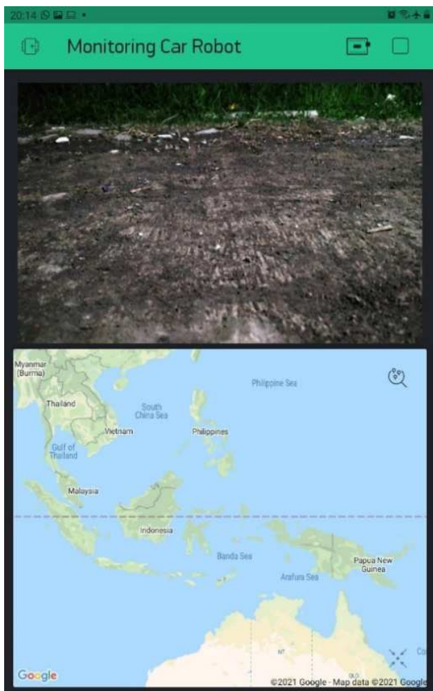
Gambar 8 Kulaitas citra yang ditangkap esp 32 cam dalam antar muka pengguna
