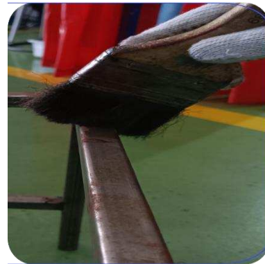
Gambar 7. Proses pengecatan rangka frame banner.
