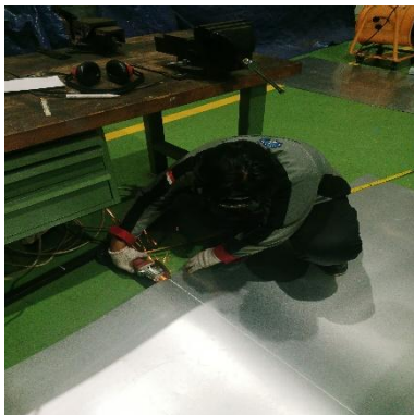
Gambar 6. Proses pemotong seng menggunakan mesin gerinda.
