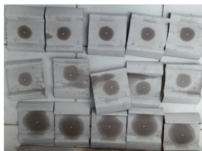
Gambar 3. Hasil pengujian pengkabutan injektor pada kertas duplex
