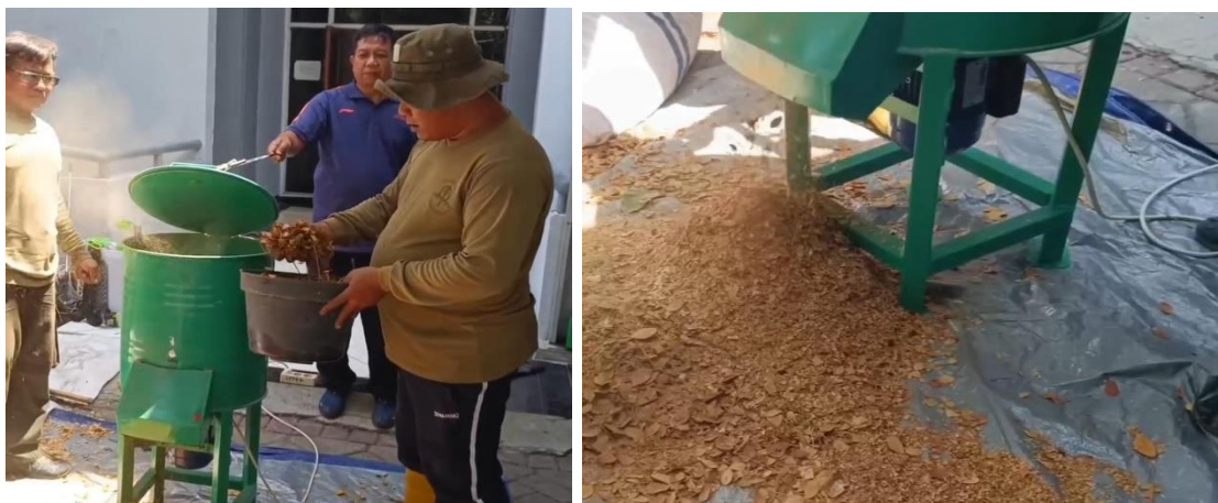
Gambar 1 Memasukkan Sampah ke dalam Alat Pencacah
