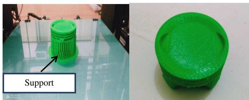
Gambar 9. Hasil manufaktur kepala piston percobaan ke dua
