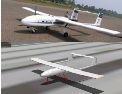
Gambar 2-2: LSU-02 riil dan model X-Plane
