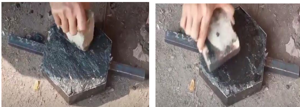
Gambar 4. Paving Block dari sampah plastik
