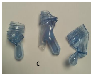
Gambar 9. a) Flat Bottom , b) Botol Bocor , c) Preform Mengkerut (Tasnim, 2017)
