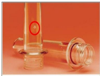
Gambar 6. Bubble pada preform (Febryani, 2016)
