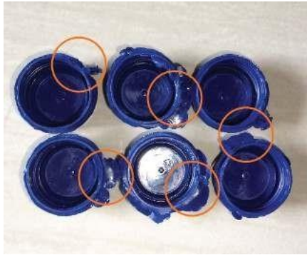
Gambar 12. Flash pada Tutup (Lestari, 2019)
