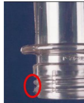
Gambar 7. Flash pada preform (Febryani, 2016)
