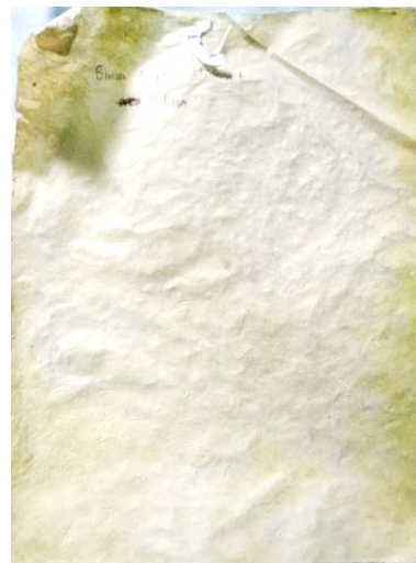
Gambar 6. Sampel C dengan perbandingan massa NaOH 50%
