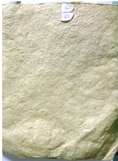
Gambar 5. Sampel B dengan Perbandingan massa NaOH 65%
