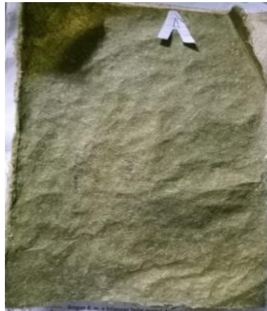
Gambar 4. Sampel A dengan perbandingan massa NaOH 100%
