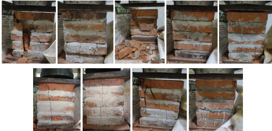
Gambar 7. Kondisi masonry prism setelah pengujian kuat tekan
