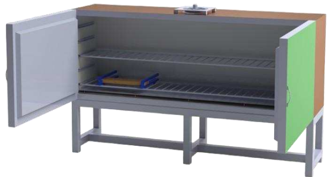
Gambar 2. Desain 3D dari oven pemanas bambu yang digunakan dalam simulasi
