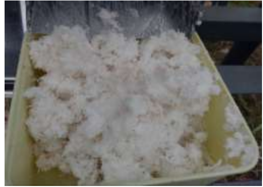
Gambar 14. Hasil Parutan Kelapa dengan Mode Kecepatan Tinggi
