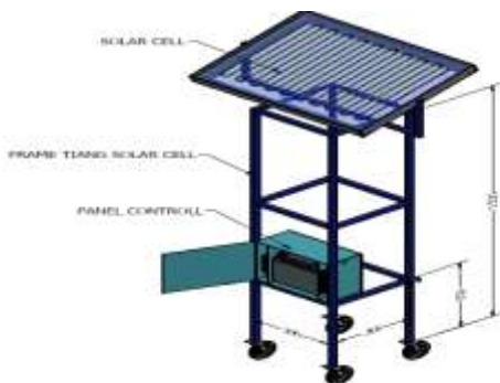
Gambar 11. Perancangan Mekanik Kerangka Panel Surya
