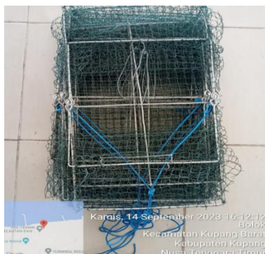
Gambar alat tangkap bubu lipat siap operasi
