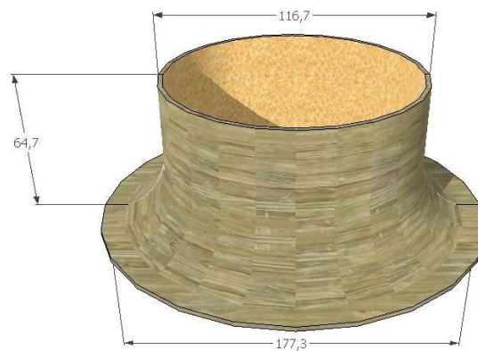
Gambar 8. Desain Profil beton tempat dasar ornamen
