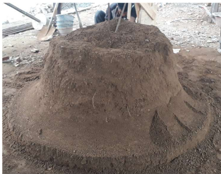
Gambar 9. Pembentukan matras pasir media pencetakan profil
