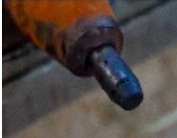
Gambar 7. Tersumbatnya nozzle pada injector Sumber: Dokumentasi pribadi
