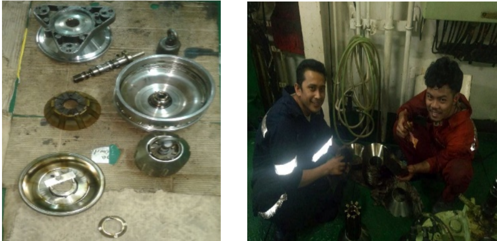
Gambar 8. Overhauling dan Pembersihan pada komponen purifier Sumber: Dokumentasi pribadi
