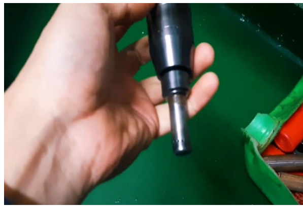
Gambar 12. Penggantian nozzle yang baru Sumber: Dokumentasi pribadi
