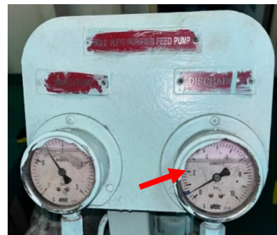
Gambar 2. Menurunnya tekanan HFO transfer pump dan HFO purifier feed pump
