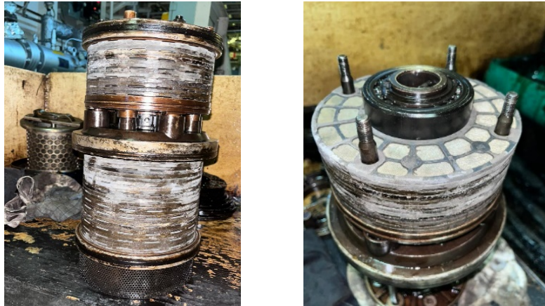
Gambar 10. Pengecekan dan pembersihan rutin pada autoback filter
