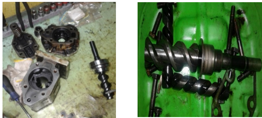
Gambar 11. Penggantian ulir serta gasket dan o-ring pada supply pump
