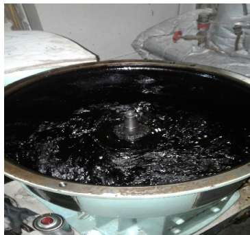
Gambar 3. Banyaknya endapan di dalam purifier
