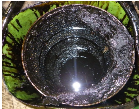
Gambar 4. Terdapat banyak sludge/endapan pada strainer HFO transfer pump
