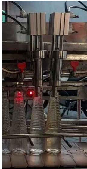
Gambar 5. Integrasi PLC Dengan Plant Pengisian Cairan Pada Botol.
