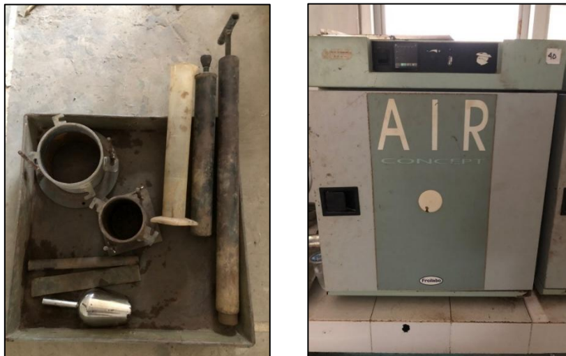
Gambar 1. Alat uji kepadan dan oven untuk uji kadar air sampel
