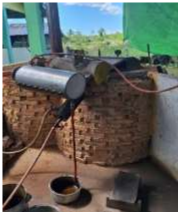
Gambar 3. Reaktor pirolisis di TPST 3R EDELWISS Kota Pontianak Sumber : Dokumentasi Lapangan, 2025
