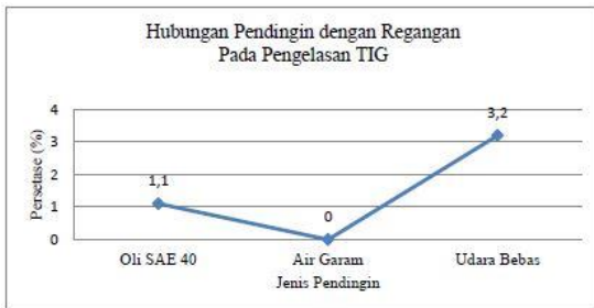
Gambar 6. Grafik Hubungan Pendingin dengan Regangan Pada Pengelasan TIG
