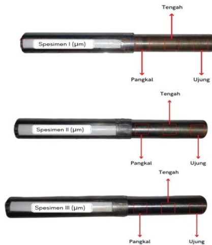
Gambar. 2. Metode Pengambilan Titik Kekasaran permukaan (Sumber : Ade Reza K, 2022)
