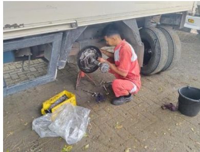
Gambar 3. Pemasangan Bak Rem Belakang
