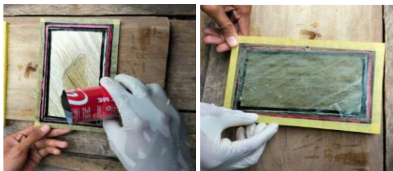
Gambar 8. Pembuatan komposit metode hand-lay-up
