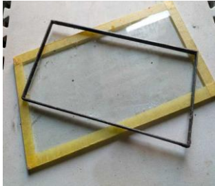
Gambar 7. Cetakan komposit ukuran P = 190 mm, L = 90 mm dan t = 5 mm
