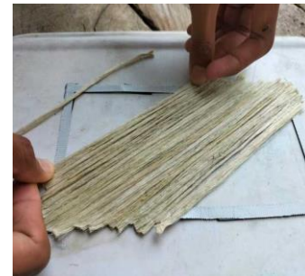
Gambar 3. Penyusunan serat pada mal cetakan
