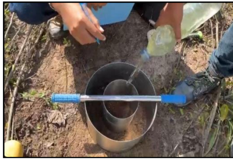
Gambar 5. Proses Pengisian Air pada Alat Double Ring Infiltrrometer
