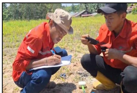
Gambar 7. Proses Pencatatan Penurunan Tinggi Muka Air pada Cincin Bagian Dalam
