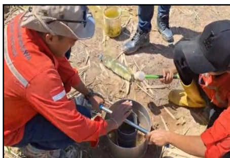
Gambar 4. Proses Pemasangan Alat Double Ring Infiltrometer
