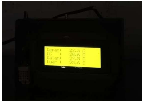
Gambar 9. Pembacaan Suhu DHT-22 (LCD I2C)
