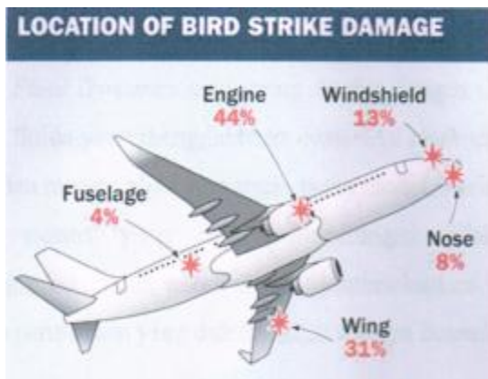
Gambar 2-4: Lokasi kerusakan pada pesawat udara akibat bird strike (Mabaso, 2011)
