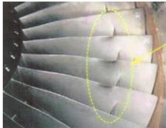
Gambar 2-6: Dent pada Leading Edge bilah kipas akibat Bird Strike (B763, 2013)
