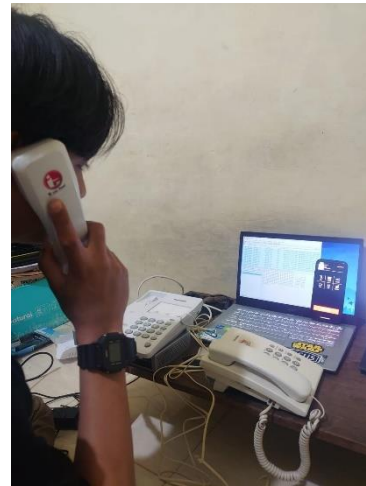
Gambar 18. pengujian panggilan antara telepon analog dengan Handphone
