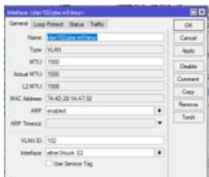
Gambar 11. Konfigurasi Sub-Interface VLAN 102
