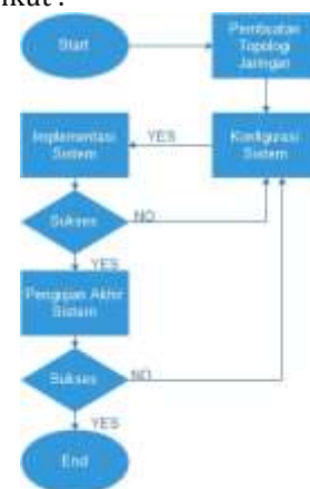
Gambar 4. Alur Konfigurasi Sistem jaringan
