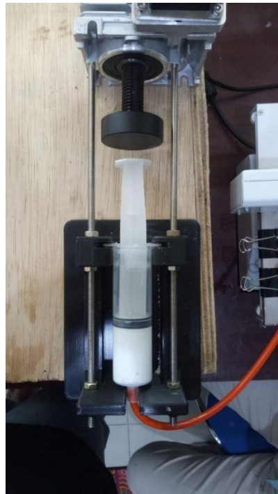
Gambar 11. Improvement pada dudukan tabung material
