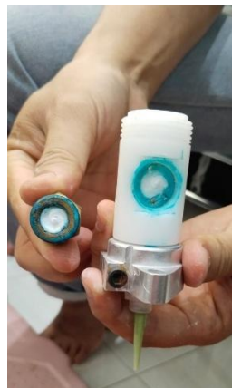
Gambar 7. saluran tabung pada mesin tersumbat
