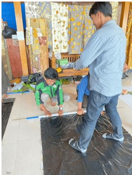
Gambar 2. penggulungan kain menggunakan alat penggulung kain
