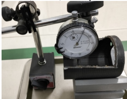
Gambar 15. Pengukuran Dial Indicator pada Intake Manifold dengan Kecepatan 20 mm/s
