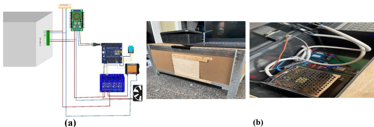
Gambar 1 (a) Wiring Diagram Alat (b) alat setelah dirancang
