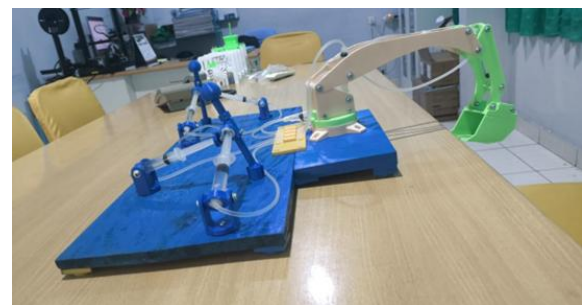
Gambar 2. Hasil Cetak 3D Simulator Excavator
