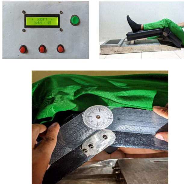
Gambar 6 Pengujian Setting dan Pengukuran Sudut Bantalan
