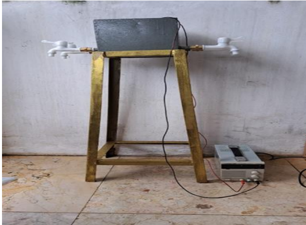
Gambar 3. Pembangkit senyawa koagulan \text{Al}(\text{OH})_3
