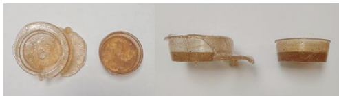
Gambar 11. Hasil sampel suhu 150°C. Kiri ke kanan (sampel 1 dan sampel 2)
