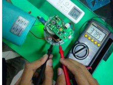
Gambar 13. Pengetesan Modul Relay
