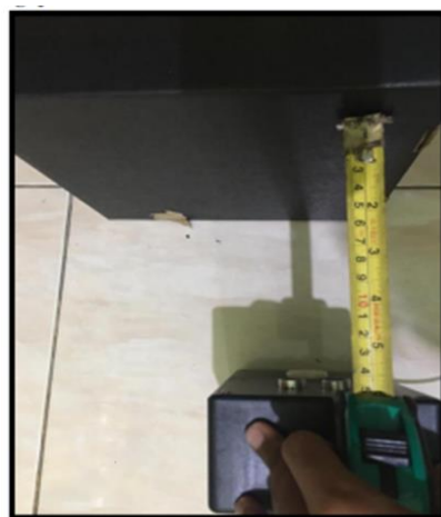
Gambar 6. Pengujian Sensor Ultrasonik HC-SR04
