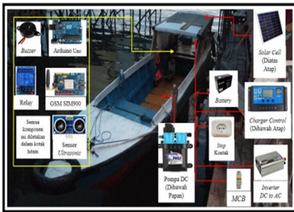
Gambar 5. Pemasangan Alat Di Kapal Nelayan
