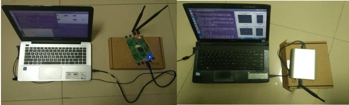
Gambar 6 Konfigurasi Tx-Rx Menggunakan USRP B210
