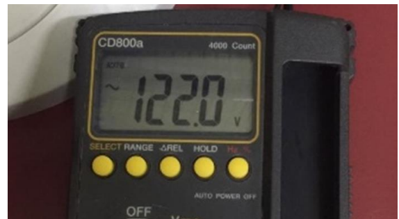
Gambar 15. Tegangan hasil pengujian pemberian beban kipas angin 45 watt
