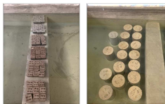
Gambar 1 Curing mortar dan beton HVFA
