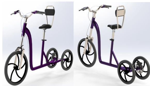
Gambar 8 rancangan rangka sepeda roda tiga tanpa pedal
