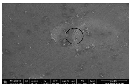
Gambar 7. Hasil SEM Bioplastik dengan berat PP-g-MA 1 gr (perbesaran 500 X).
