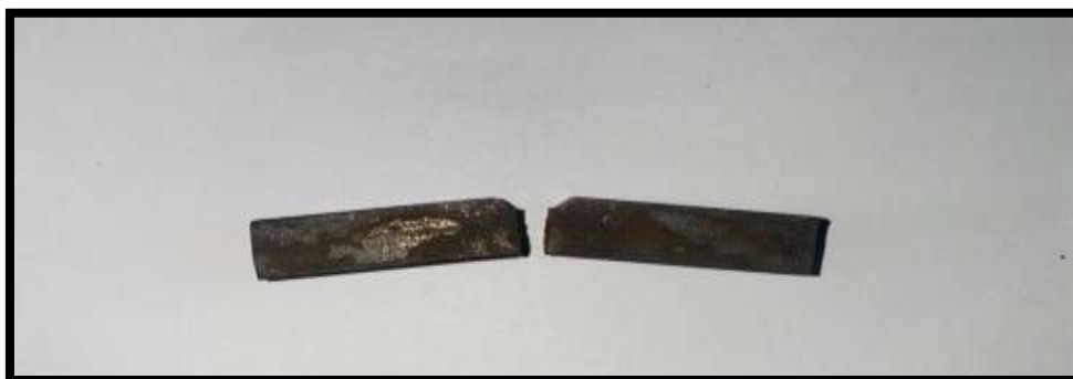
Gambar 15 Hasil Pengujian Dengan Quenching Media Air
