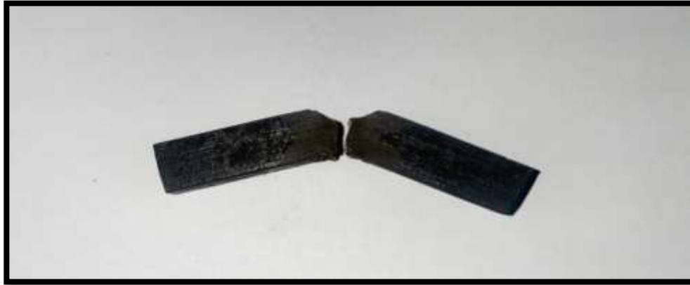
Gambar 16 Hasil Pengujian Dengan Quenching Media Oil
