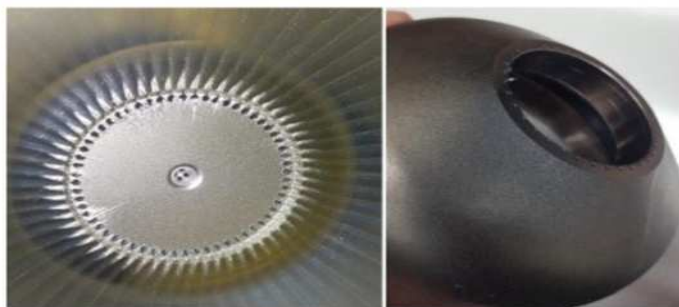
Gambar 3. Kondisi tidak normal Bel Cup dan Shaping Ring saat seteah spray
