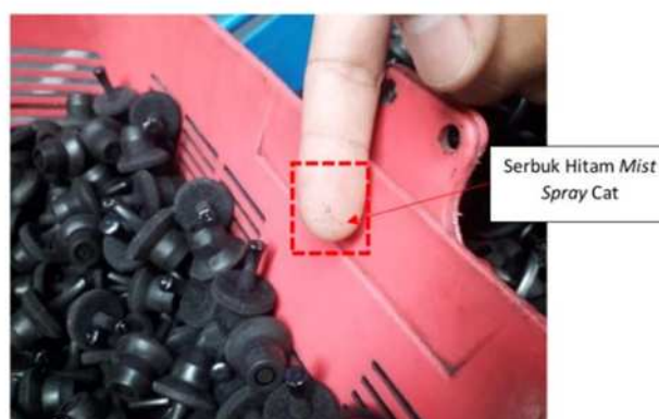
Gambar 5. Jig Bolt penuh dengan Mist Sprasy berpotensi terbentuknya Kuro Butsu
