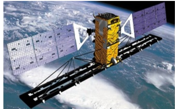
Gambar 1-2: Deployable panel surya pada satelit SAR ALOS 2 (Sumber: eoportal.org)
