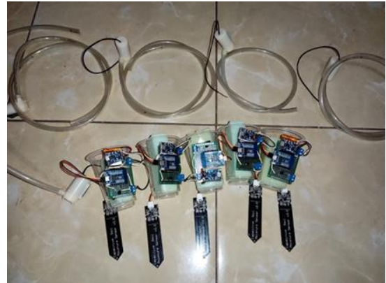
Gambar 5. Rancangan 5 buah node sensor
